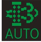
La régénération du filtre DPD est déclenchée et se termine de façon complètement automatique, pendant la conduite du véhicule. Pendant cette régénération, le voyant DPD (vert) reste allumé.
