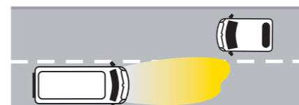
BASCULEMENT AUTOMATIQUE DES FEUX entre feux de route et feux de croisement lorsqu'un véhicule est détecté jusqu'à 600 mètres de distance, même en cas de dépassement.
