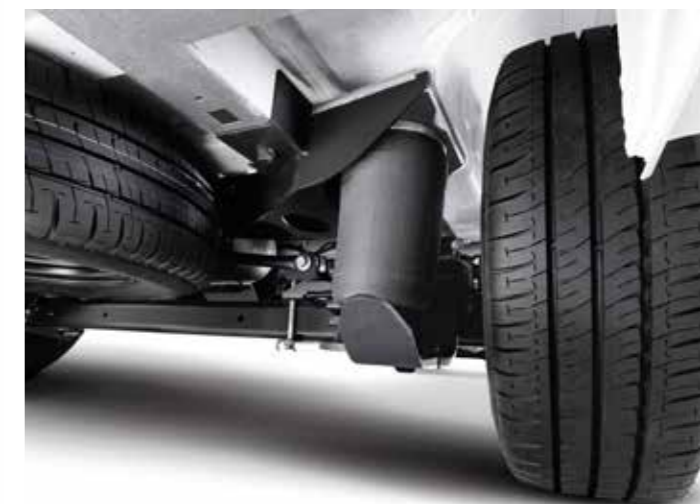
SUSPENSION PNEUMATIQUE pour stabiliser le véhicule lors des passages d'obstacles quel que soit le niveau de chargement.
