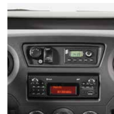
COMMANDES À PORTÉE DE MAIN POUR L'ACTIVATION DE L'ÉCLAIRAGE et la programmation de la climatisation et du chauffage.
