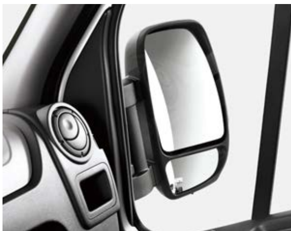
RÉTROVISEURS GRAND ANGLE à réglage électrique avec clignotants intégrés.
