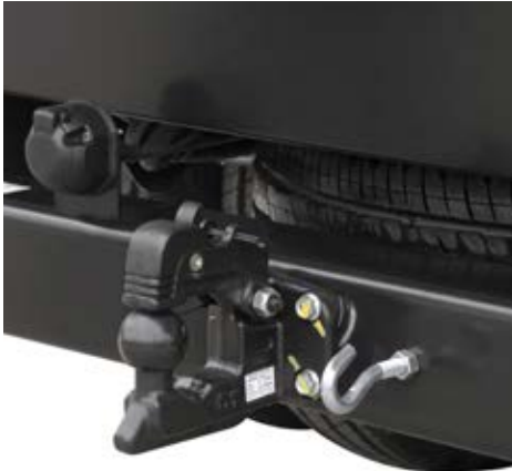
CROCHET DE REMORQUAGE pour augmenter le volume de chargement.
